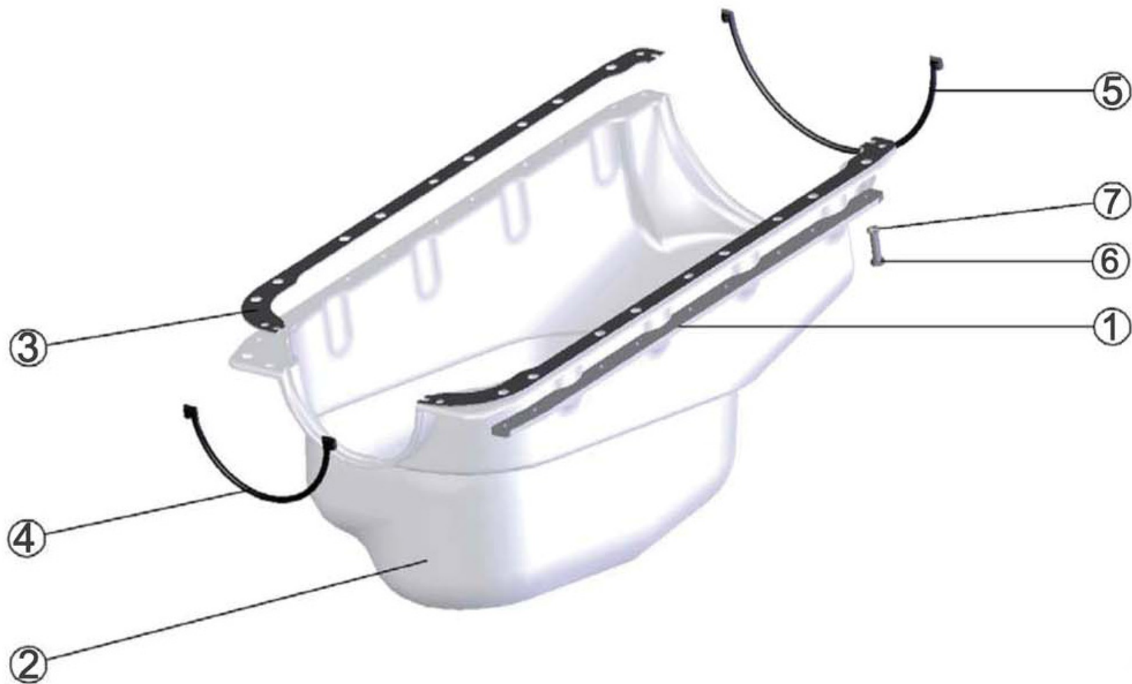
Рис. 8 Установка картера масляного
