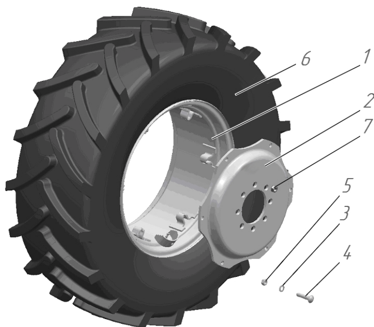
Рис. 31.1. Колеса передние ведущие
